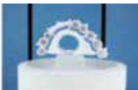
Positionnement correct sur le support de frittage
