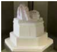
Platzierung Brücken mit Sinterbalken ab 9 Gliedern
