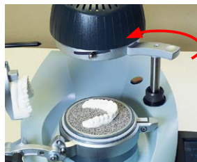
7. ... unter die Heizung schwenken. Der Heizvorgang startet.
