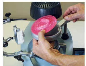
11. Folienspannung lösen, den Occluform-3-Modelltopf mit der Folie entnehmen
