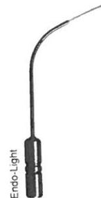
Wurzelfrakturen können oftmals durch Einsatz der Endo-Glasfaser Spitze lokalisiert werden. Die Spitze entweder bukkal oder lingual im gingivalen Sulcus platzieren. Eine Frakturlinie erscheint durch die Transillumination von außen in das Kanalinnere dunkel. **Oben gezeigt: Endo-Lichtleiter Art.-Nr. 640035**
