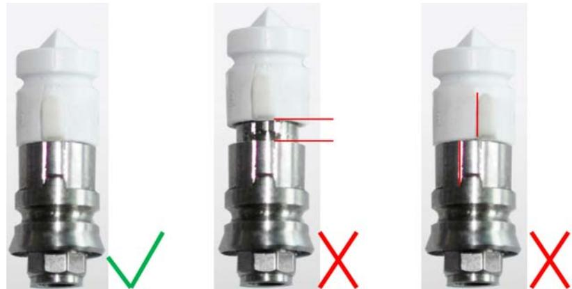
4. Posizionare il corpo di scansione sul perno. Assicurarsi che il corpo di scansione sia inserito completamente e che i contrassegni su corpo di scansione e perno formino una linea. Con CEREC Omnicam dovrebbero essere impiegati solo i modelli "Scanbody for Omnicam" grigi. Gli utenti di CEREC Bluecam dovrebbero utilizzare esclusivamente i modelli "Scanbody for Bluecam" bianchi, forniti ad es. anche con TiBase.
