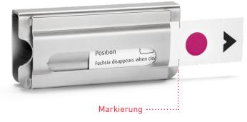
oben weisend so auf den Rücken legen, dass sich die aus den Halterungen herausragenden Teile der Indikatorplättchen zentrisch über den Ultraschallgebern befinden. Ultraschall-Reinigungsprogramm 5 min. durchführen.
