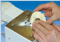
25. Zahnkranz mit Zahnkranzschleifer oder Handstück bearbeiten
