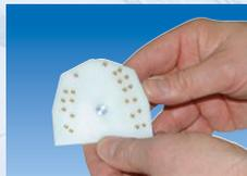
15. Fertig mit Pins bestückte Sockelplatte
