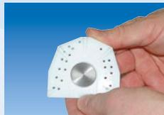
13. Fertig gebohrte Sockelplatte
