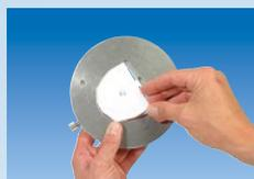
9. Sockelplatte in den Plattenhalter des Pinbohrgerätes setzen
