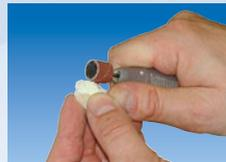
27. Einzelne Segmente mit Schleifbändern weiterbearbeiten
